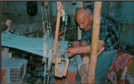
Dokumaların büyük çoğunluğu "bezayağı" tekniği ile yapılır. İkinci olarak kullanılan teknik ise "dimi" örgüsü ve türevleridir.
