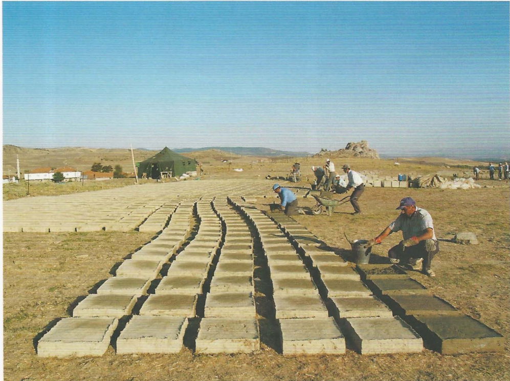
32. Kerpiç tuğlalar kuruma sırasında yaklaşık 10 litre su kaybediyor
