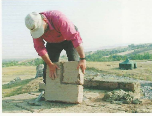
55. Tuğlalar sertliklerinden ötürü ancak balta ile kesilebildiler
