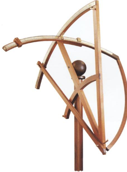
Şekil 2. 14 Müşebbehe bil menâtık gözlem aracının günümüzde oluşturulan hali [3]
