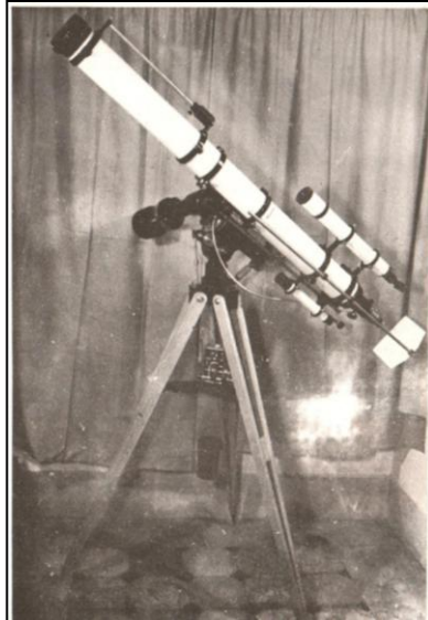
Şekil 2. 30 Güneş tutulmaları için kullanılan 200 cm odak uzaklıklı, 12 cm çaplı Unitron dürbünü [81]
