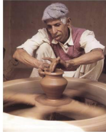
Resim 4: Hindistan'da Kullanılan El Tornası.
