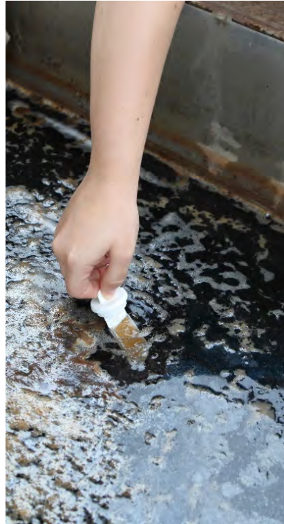
Fig.4 Biyolojik aktivasyonun yoğunluğunun tespiti için dipslide ile yapılan ölçümler.
