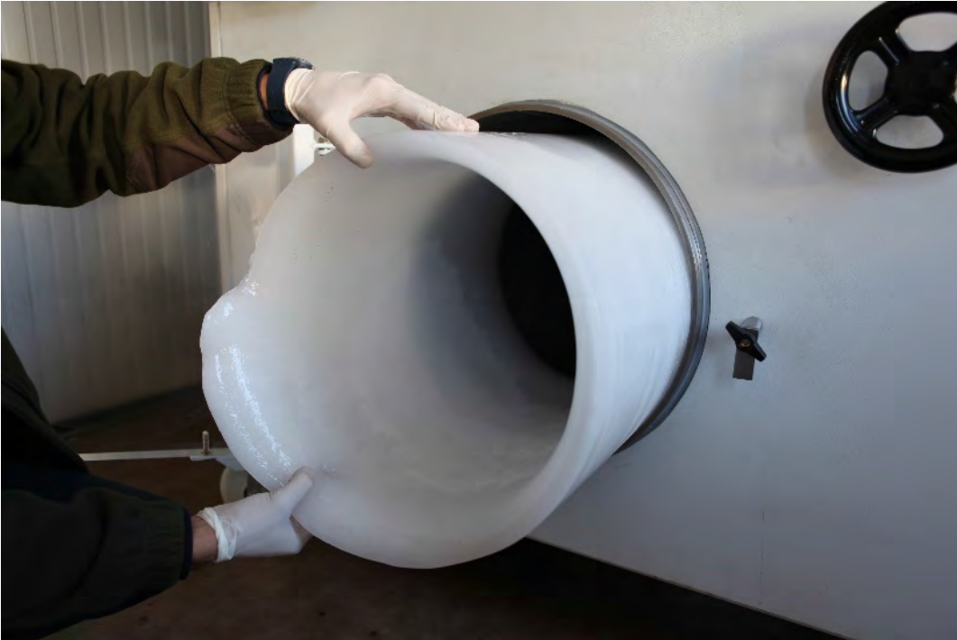
Fig. 8 Çamaltı Burnu 1 Batığı ahşaplarının içerisindeki suyun süblimleşip kondansörde buz olarak toplanması.
