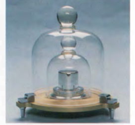
Saklama ünitesi içinde Kanada standart kilogramı. Platin ve iridyumdan yapılmış bu cisim, Paris yakınlarındaki Sevr'de yer alan Uluslararası Ağırlık ve Ölçüler Bürosu'nda saklı olan uluslararası kilogram prototipinden üretilmiştir.
