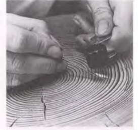
Dendrokronoloji. Halkaları sayılarak ağacın yaşı öğrenilebilir. Resimde görülen numune, güneybatı ABD, Arizona'daki, Kırık Flüt Mağarası'nda yer alan bir çukur evin dikey çatı desteğine ait. Araştırmacının çubuğu MS 543 halkasının üzerinde duruyor.
