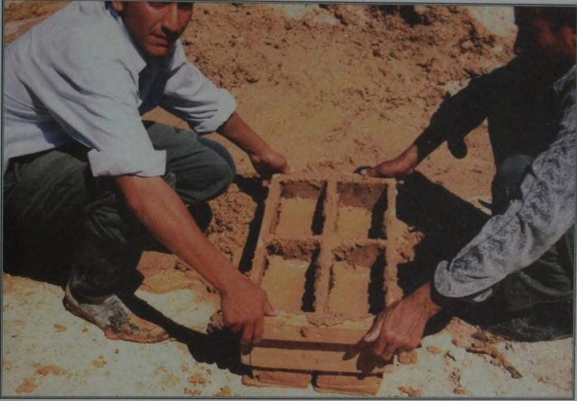
Resim 161: Kerpiç, Kalıp Çıkarılırken/Kâhyalı
